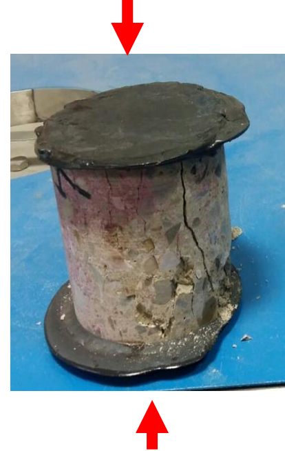
Stadio 4: crisi per rottura della sezione
